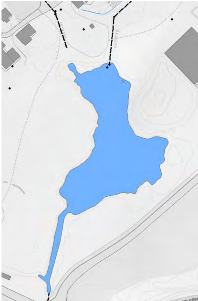
Figur 9. Oversikt over OV-utslipp til vannspeilet, DN500 og DN315.
