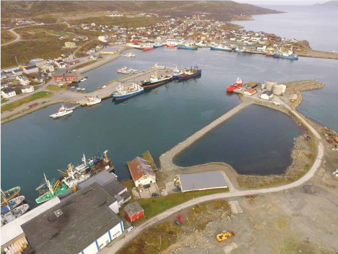
Dronebilde som er tatt i forbindelse med mudrings-jobb av Kystverket. Sjete og fylling er opparbeidet i samarbeid med Båtsfjord Havn KF.
